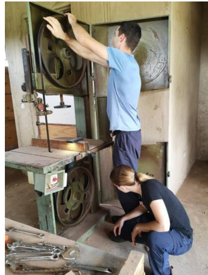
Anpassen der Bandsäge, damit sie richtig herum läuft
